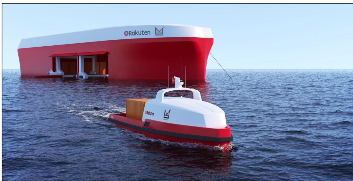
Figur 9-10: Det 22 meter lange konseptfartøyet K22 designet for frakt av to 20-fots containere (Teknisk Ukeblad, 2018).
