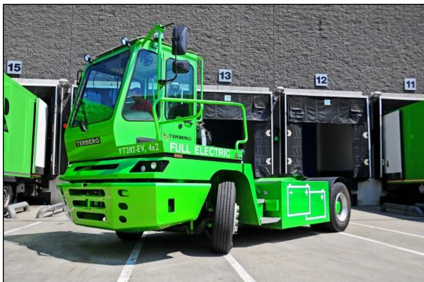
Figur 9-11: Terberg YT202-EV, terminaltraktor med elektrisk fremdrift (Terberg, 2018).
