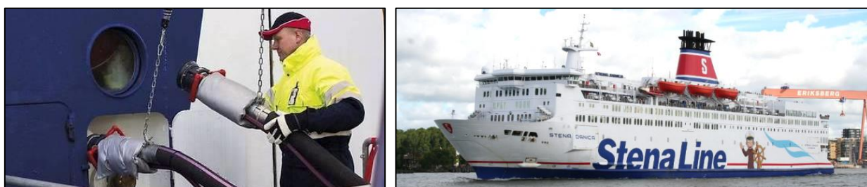
Figur 9-14: Tilkobling av fjernvarmeløsningen på «Stena Danica» ved kailigge for å erstatte dieselbruk på oljefyrte kjeler (Norsk Fjernvarme, 2018).
